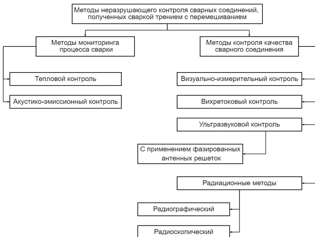
**Рис. 1. Классификация методов неразрушающего контроля применительно к сварным соединениям из меди, полученных СТП**
