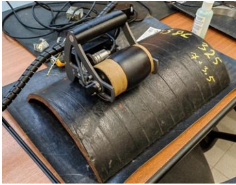
Рис. 1. Роликовый фазированный датчик с матрицей на 64 элемента.
