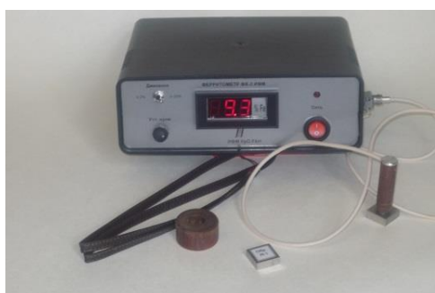
Рис. 1. Ферритометр ФХ-3-ИФМ для локальных измерений процентного содержания феррита в аустенитных сталях.
