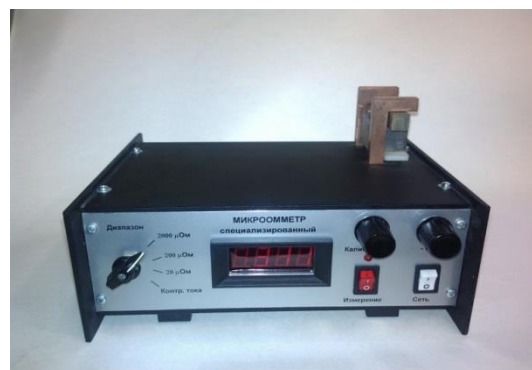
Рис. 4. Прибор «МИКРООММЕТР специализированный» для измерения удельного электрического сопротивления.
