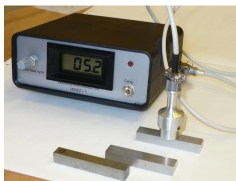
Рис. 2. Прибор ИМДС для контроля содержания фазы мартенсита.
