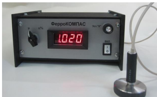
Рис. 3. Прибор «ФерроКОМПАС» для измерения величины относительной магнитной проницаемости \mu .
